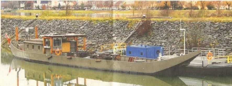
Um den heutigen Richtlinien der Schifffahrt zu entsprechen, müssen zwei Schiffe in einem gebaut werden. Das genehmigungsfähige Fahrgastschiff wurde aus Stahl gebaut und hat im Sommer 2007 in Landshaag angelegt. Dort wird es nun in ein historisches Donauschiff verwandelt.
